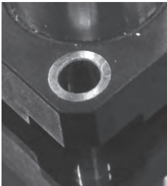
写真6 ボルトを通す穴にカラーを設置
