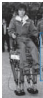
従来の滑りの球面軸受は大きな摩擦抵抗と内部隙間によって滑らかな動きに少なからず問題がありました。パラレルメカニズムを基本構造とする人間搭乗型2足歩行ロボットの足首にこの転がり球面軸受を装着することにより、スムーズな動作と耐久性を実現しました。
